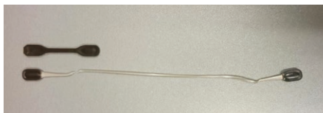
Rys. 2. Próbkę LLDPE z dodatkiem 5% popiołu przed i po badaniu na maszynie wytrzymałościowej
